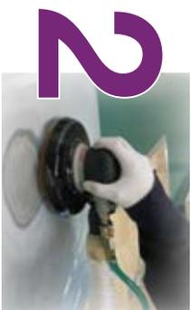
Lije el área dañada y la superficie circundante con disco Imperial HookIt™ II de grano P80E de 6" NP 00683 para uso con el respaldo NP 05276, elimine los restos de polvo con aire comprimido y un trapo limpio y seco.
