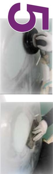
Lije con disco HookIt™ II de grano P80E NP 00683 y posteriormente lije con disco HookIt™ II de grano P180 NP 00679, utilice bloqueo manual para áreas planas, posteriormente aplique el revelador de rayas sobre el rellenedor NP 05861.
